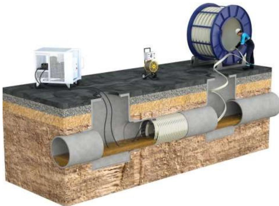
Намотка новой трубы, с использованием навивочной машины, производится на строительной площадке требуемой длины и диаметра.
